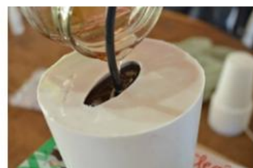
Figura 3: Utilização da resina no sensor.
