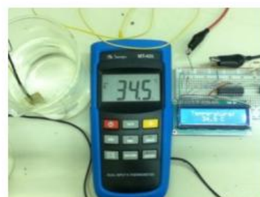
Figura 5: Processo de calibração do sensor. Fonte: Os autores
