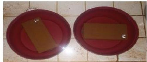
**Figura 4:** Corpos-de-prova submersos para perda de massa.
